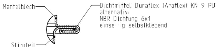
Bündelnaht mit Dichtung
