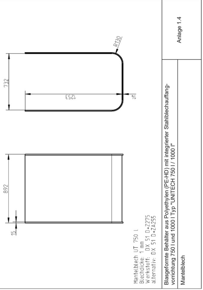
Blasgeformte Behälter aus Polyethylen (PE-HD) mit integrierter Stahlblechauffangvorrichtung 750 l und 1000 l Typ "UNITECH 750 l / 1000 l"
