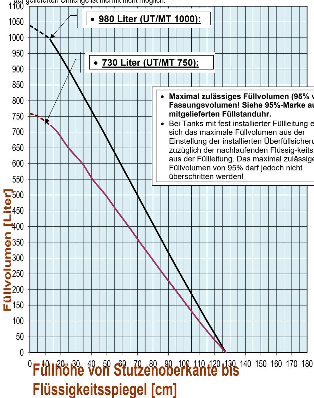
Maße auf volle **cm** auf- bzw. abgerundet. Messung mit Zollstock oder Maßband von Oberkante Tankstutzen bis auf den Flüssigkeitsspiegel. Zwischenwerte interpolieren.
