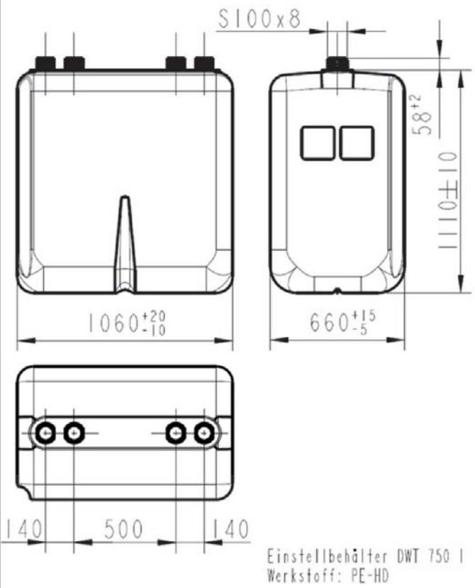
Blasgeformte Behälter aus Polyethylen (PE-HD)
