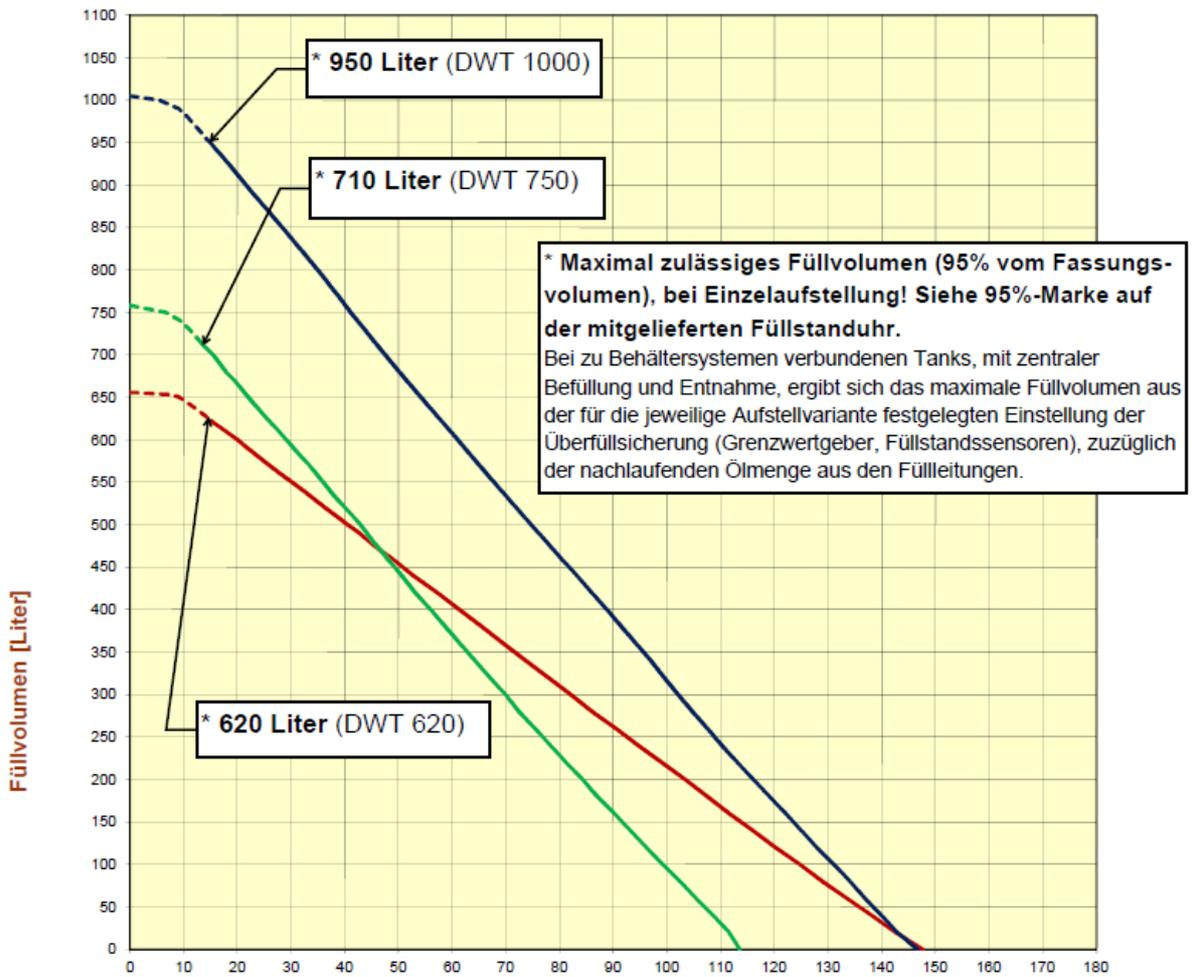
**Füllhöhe von Stutzenoberkante bis Flüssigkeitsspiegel [cm]**
