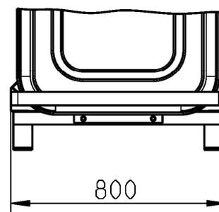
Blasgeformte Behälter aus Polyethylen (PE-HD)
