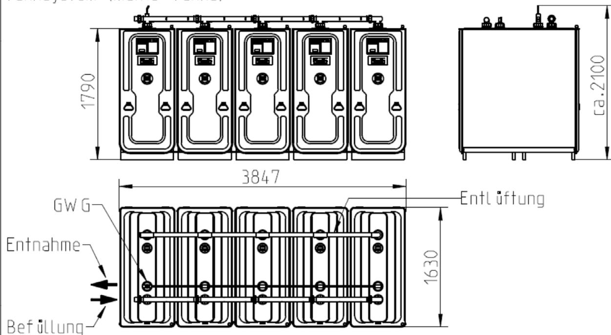
Blasgeformte Behälter aus Polyethylen (PE-HD)
