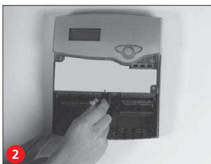
1. Kreuzschlitzschraube in der Blende herausdrehen und Blende nach unten vom Gehäuse abziehen. Danach Kreuzschlitzschrauben in Klemmenabdeckung herausdrehen und Abdeckung abheben.
