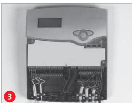
3. Gehäuse am oberen Befestigungspunkt einhängen, unteren Befestigungspunkt auf dem Untergrund markieren (Lochabstand 160 mm, siehe Sockelrückseite), anschließend unteren Dübel setzen. Gehäuse oben einhängen und mit unterer Befestigungsschraube fixieren.
