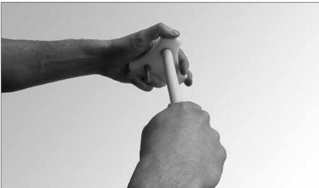
Rohrenden mit dem Roth Kalibrierwerkzeug kalibrieren und entgraten, um O-Ringe bei der Montage von Rohr und Fitting nicht zu beschädigen.
