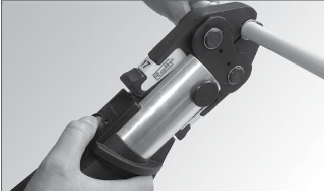
Startknopf am Presswerkzeug betätigen und Verpressung durchführen.
