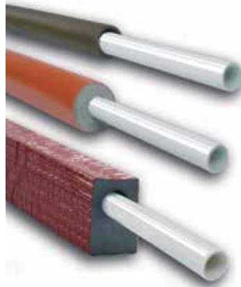
Die häufigste Anwendung stellt die umgangssprachliche 100%-Dämmung dar. Diese entspricht in Abhängigkeit der Dimension der Einbausituation Nr. 1 und 2. Das heißt alle warmgehenden zirkulierenden Rohrleitungen wie Wärmeverteilungen, Trinkwasser warm und Trinkwasser Zirkulation sind mit einer Dämmstärke zu ummanteln, die mindestens dem Innendurchmesser der Rohrleitung entspricht, bei Verwendung von Dämmstoffen mit einer Wärmeleitfähigkeit von  $\lambda = 0,035 \text{ W}/(\text{m}\cdot\text{K})$ .
