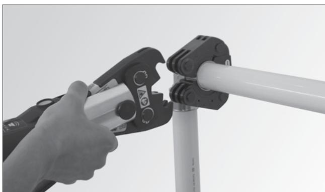
Einlegen der Pressschlinge in die Grundbacke.
