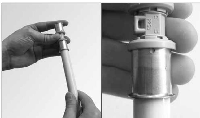
Rohr auf Fitting stecken, richtige Rohrposition durch Sichtfenster in Presshülse kontrollieren.
