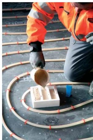
Zur Überprüfung der Estrichmischung wird die Fließfähigkeit anhand der Ausbreitung auf einer Glasplatte getestet und Probebehälter für Prüfprismen gefüllt. Die ausgehärteten Prüfprismen dienen zur Messung der Biegefestigkeit des Estrichs.
