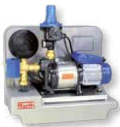
Komplettmodul mit eingebautem Hauswasserwerk und Nachspeisung direkt zur Pumpe ohne Umweg über den Speicher. Maximale Förderhöhe der Pumpe 36 m, maximale Fördermenge 3 m<sup>3</sup>/h; maximale Ansaughöhe 3 m und maximale Saugleitungslänge 15 m.
