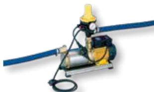
4-stufige horizontale Kreiselpumpe, selbstansaugend mit integriertem Trockenlaufschutz, Leistungsaufnahme 700 W, Förderhöhe maximal 42 m, Fördermenge 3,5 m<sup>3</sup>/h, Ansaughöhe 3 m, Saugleitungslänge 15 m, Lieferung inklusive Pumpenanschluss-Set und Pumpenkonsole.
