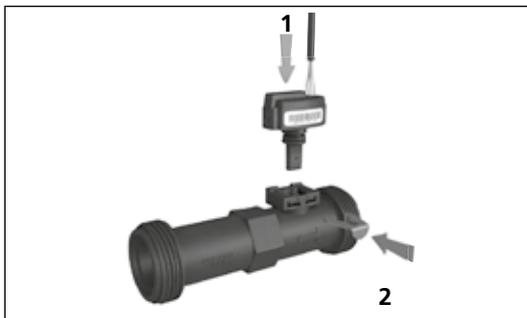
Sensor mit Kabel (1) in die Messstrecke (2) stecken und mit Sicherungsklipp befestigen.
