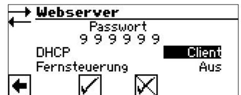
Der Heizungs- und Wärmepumpenregler bezieht dann seine Verbindungsdaten automatisch von dem DHCP-Server (z.B. Router).
