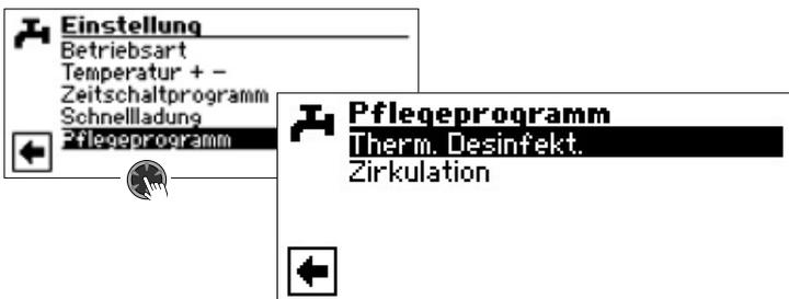
Die thermische Desinfektion ermöglicht, die Trinkwassertemperatur mit einem zusätzlichen Wärmeerzeuger (ZWE) auf eine höhere Temperatur zu bringen als jene, die mit der Wärmepumpe erreichbar ist. Die thermische Desinfektion wird ausschliesslich über zusätzliche Wärmeerzeuger bereit; der Verdichter der Wärmepumpe bleibt ausgeschaltet.
