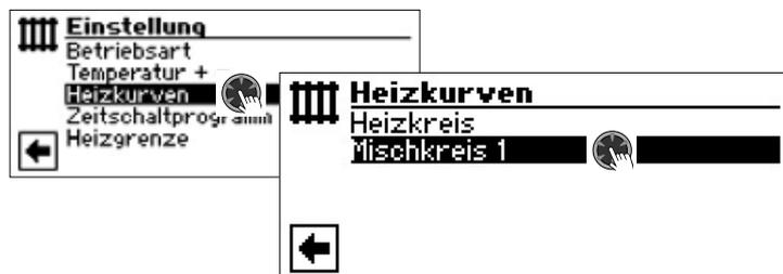
Der Bildschirm wechselt in das Menü „Heizung Heizkurve MK1“. Die Heizkurven können programmiert werden, sofern keine Festtemperatur definiert ist.
