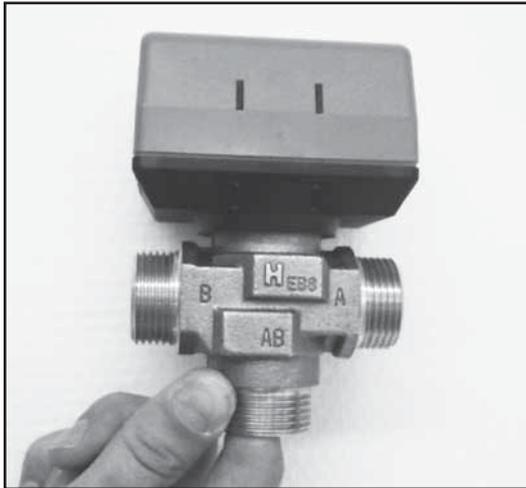
Um auszuschließen, dass eventuell anfallendes Kondensat nicht in das innere der solaren 2- und 3-Wege-Motorstellventile (siehe Anlagenhydraulik R2, R4 und R7) gelangt, ist auf die korrekte Einbaulage zu achten!
