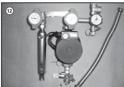
12. Die restlichen Bauteile der Solarstation müssen unbedingt erst **nach** der Montage diffusionsdicht isoliert werden. Es ist immer bei der Isolierung darauf zu achten, dass keine Luftspalte entstehen. Jeder offene, nicht isolierte Stelle führt eventuell zum Kondensatanfall.
