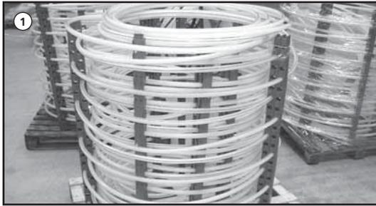
1. Die einzelnen Register verfügen über jeweils 9 Doppelschienenständer mit denen die Rohre im vorgegebenen Höhenraster fixiert sind. Die Roth Solargeo® E<sup>x</sup> Register werden im aufgerollten und in Schutzfolie verpackten Zustand angeliefert.
