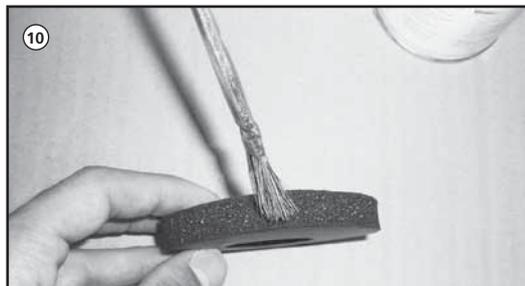
11. Auch auf der Seite, die mit der hydraulischen Weiche in Kontakt steht, muss Klebstoff aufgetragen werden.
