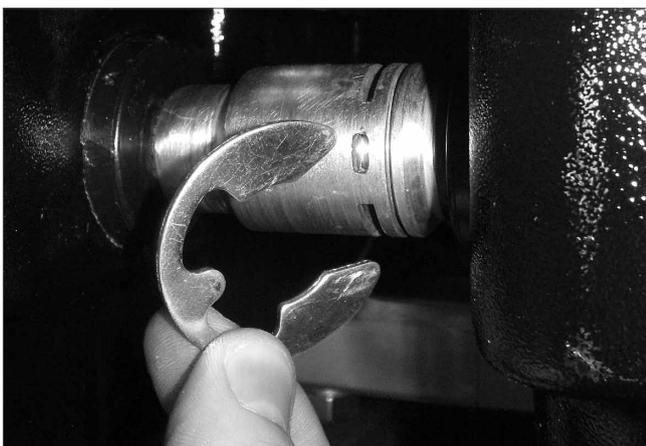
Das ineinandergeschobene Stecksystem mit Hilfe des Sicherungs-rings verbinden.
