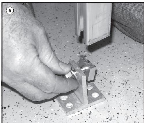
6. Die vorbereitete Verbindung wird in die Montageschiene eingesteckt und fixiert. Dieser Vorgang ist an dem unterem Ende der senkrechten und schräg laufenden Schiene durchzuführen.
