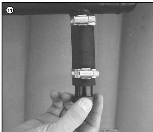
**11.** Das offene Schlauchende ist mittels Endstopfen zu verschließen und ebenfalls mit der Schlauchschellen zu befestigen.
