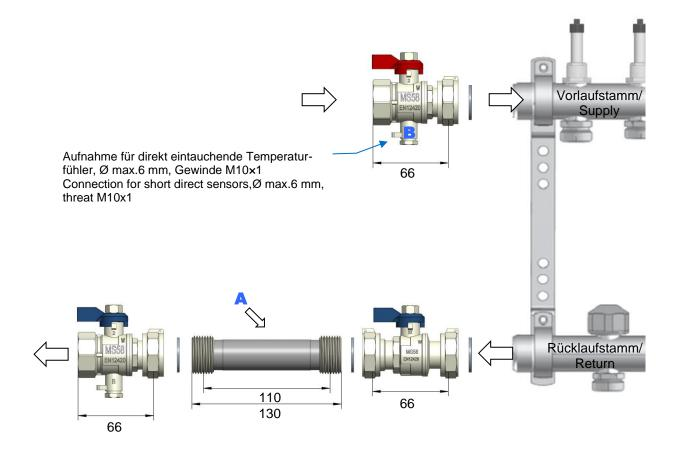
Das Roth Wärmemengenzähler Einbauset waagerecht kann mit dem Roth Heizkreisverteiler Universal oder mit Durchflussanzeige eingesetzt werden.
