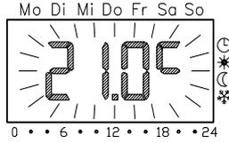
Diese kann nun mit den + und – Tasten verändert werden. Mit der SET-Taste wird die eingestellte neue Temperatur bestätigt. Auf diese Temperatur wird bis zur nächsten Schaltzeit des Zeitprogramms geregelt, dann wird die Temperatur des Zeitprogramms wieder wirksam.
