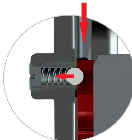
Der Gewindestift wird soweit in das Gehäuse gedreht, dass der Klips durch die Kugel gehalten wird und der Tackerstempel den Klips ohne verhaken nach unten schieben kann.
