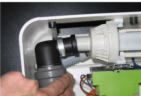
Pumpenanschlussstutzen auf Pumpengehäuse aufschieben.
