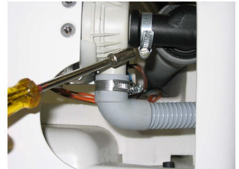
Pumpenanschlusssutzen vom Pumpengehäuse abziehen. Dichtring im Pumpenanschlusssutzen beachten.
