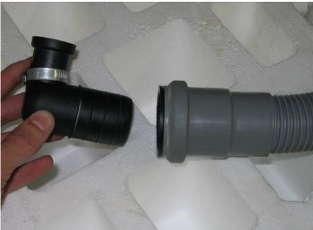
Pumpenanschlussstutzen aus Abwasserschlauch herausziehen.
