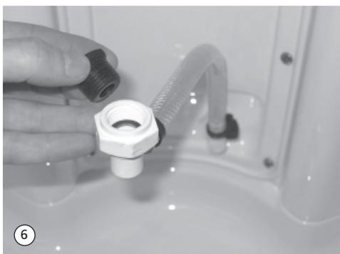
6. Verschließen Sie den Schlauch nach dem Einfüllen des Entkalkers mit dem Verschlussstopfen.
