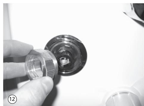
13. Begrenzer so aufstecken, dass die Sperrkante mit der Markierung für 38°C nach oben steht.
