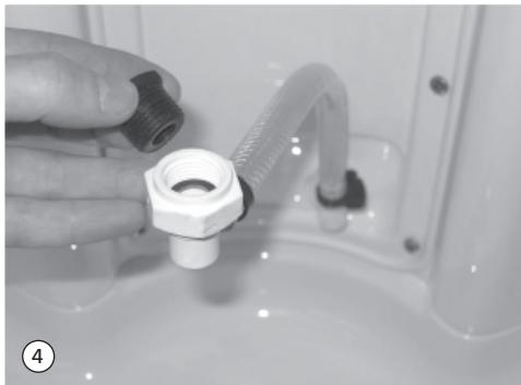
4. Entfernen Sie den Verschlussstopfen des Einfüllschlauches.
