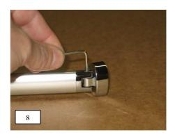
9. Den Gelenkkopf durch Herausdrehen der Schraube 3,5 x 32 mm demontieren.
