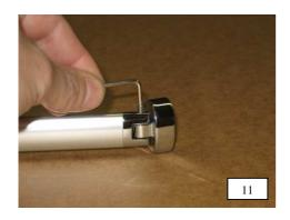
11. Gelenkkopf und -platte in umgekehrter Reihenfolge am gekürzten Halterohr montieren.
