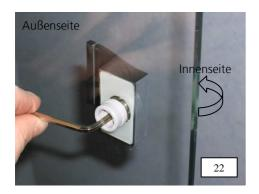
22. Erste Griffhälfte gemeinsam mit der Griffunterlage auf der Innenseite der Scheibe anlegen und mittels Senkschraube M6 x 20 und der Befestigungshülse aus Kunststoff von der Außenseite her durch die Bohrung hindurch befestigen
