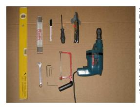
Schlagbohrmaschine mit Steinbohrer Durchmesser 8 mm Wasserwaage Bügelsäge Gliedermaßstab Innensechskantschlüssel SW 2 Innensechskantschlüssel SW 2,5 Innensechskantschlüssel SW 4 Steckschlüssel T15 Ringmaulschlüssel SW 13 Schraubendreher Kreuzschlitz Bleistift Schere (Dichtungen zuschneiden) Werkzeuge
