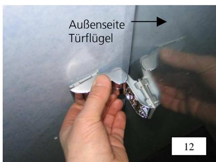
12. Beschlagabdeckungen am Türflügel und am Seitenteil montieren. Dabei Zuordnung Links „L“ und Rechts „R“ beachten. Vor Montage der türseitigen Beschlagabdeckungen nochmals alle Befestigungsmuttern M8 mit einem Drehmoment von 15 Nm anziehen.
