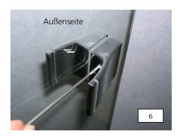
Zweite Griffhälfte zusammen mit der Griffunterlage von außen über die Befestigungshülse schieben und durch Eindrehen des Gewindestiftes M5 auf der Befestigungshülse fixieren. Gewindestift hierbei fest anziehen
