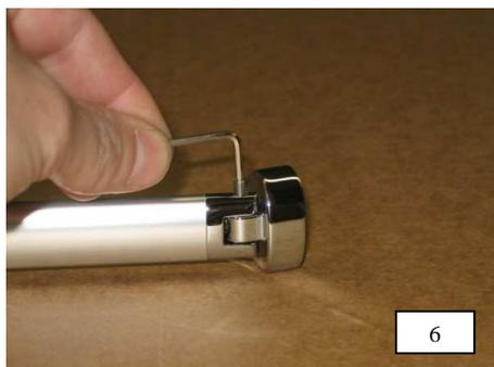
6. Gewindestift M4 x 16 mit Innensechskantschlüssel SW 2 herausdrehen, bis Gelenkplatte zu entnehmen ist.
