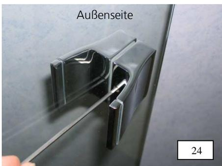
24. Zweite Griffhälfte gemeinsam mit der Griffunterlage von außen über die Befestigungshülse schieben und durch Eindrehen des Gewindestiftes M5 auf der Befestigungshülse fixieren. Gewindestift hierbei fest anziehen. **Die rechte Abtrennungsseite kann nun ebenso montiert werden. Anschließend von beiden Abtrennungshälften das Kantenschutzprofil komplett entfernen.**
