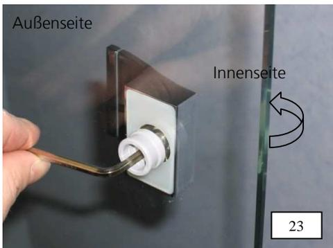
23. Erste Griffhälfte gemeinsam mit der Griffunterlage auf der Innenseite der Scheibe anlegen und mittels Senkschraube M6 x 20 und der Befestigungshülse aus Kunststoff von der Außenseite her durch die Bohrung hindurch befestigen.
