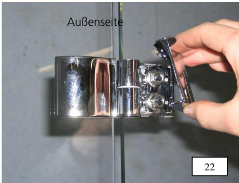
22. Beschlagabdeckungen montieren. Dabei Zuordnung Links „L“ und Rechts „R“ beachten. Vor Montage der Beschlagabdeckungen nochmals alle Befestigungsmuttern M8 mit einem Drehmoment von 15 Nm anziehen.
