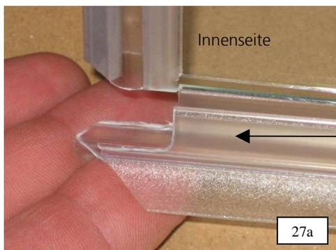
26. Wannendichtung ausklinken, und am Türflügel montieren. Die Länge wird bündig mit der Scheibenhinterkante zugeschnitten.
