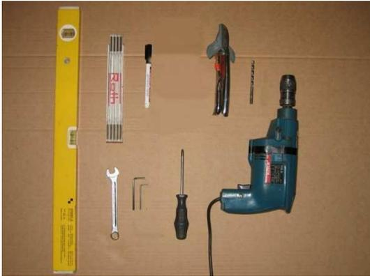
Schlagbohrmaschine mit Steinbohrer
