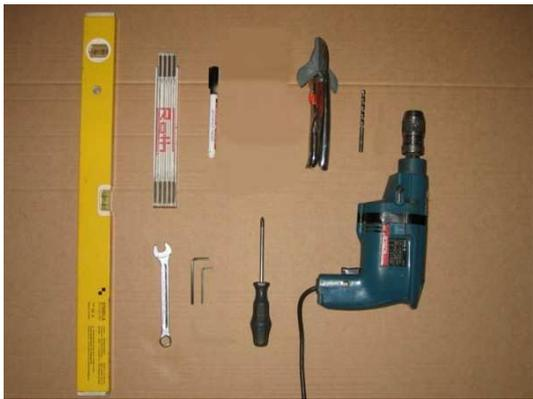
Schlagbohrmaschine mit Steinbohrer
