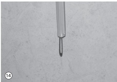
14. Die graue Gelenkdichtung muss beim Montieren so positioniert werden, dass das zweilagige Ende der innenliegenden Verstärkung unten ist.
