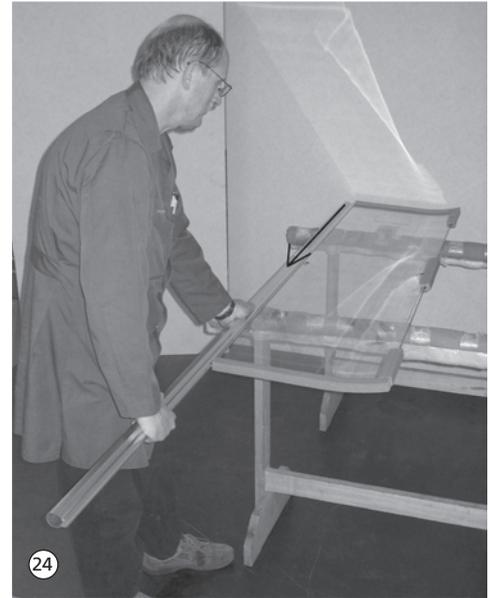
25. Außenprofil auf den Türflügel aufschieben. Anschließend den Türflügel auf die Gelenkeinheit montieren, wie unter Punkt 17 bis 22 beschrieben.
