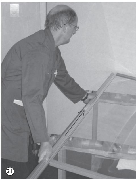
21. Die beiden Flügel tauschen und das rechte Außenprofil auf den entsprechenden Flügel aufschieben. Anschließend diesen Flügel auf die rechte Gelenkeinheit montieren. Mit dem linken Außenprofil und dem 2. Flügel ebenso verfahren und dann auf die linke Gelenkeinheit montieren.
