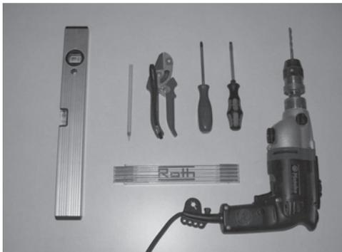
Schlagbohrmaschine mit Steinbohrer
