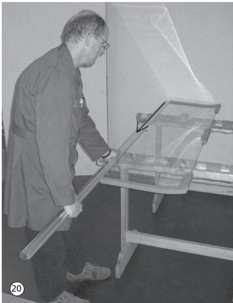
20. Rechtes Außenprofil vom rechten kleinen Flügel abziehen und gleiches mit dem linken großen Flügel vornehmen.
