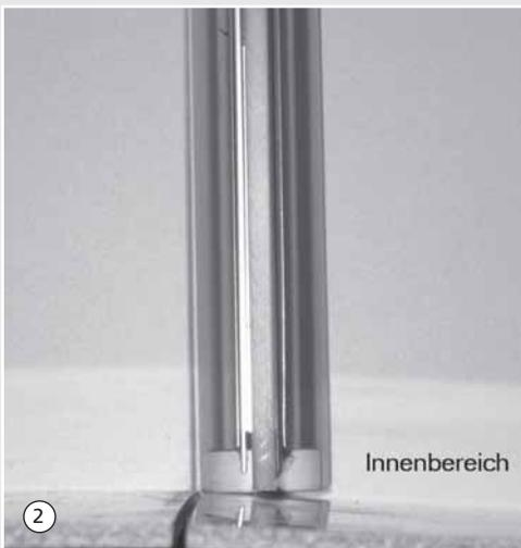
2. Bei Montage auf Fliesenboden ist darauf zu achten, dass die Gelenkeinheiten in den Innenbereich des Gefälles montiert werden. Vorteil: austretendes Wasser kann sofort in den Innenbereich zurück laufen.
