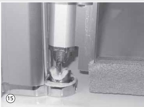
15. Geraden Flügel auf den Drehzapfen der unteren Gelenkplatte aufsetzen. Auf die Bezeichnung der Flügel achten (oben, außen links).
