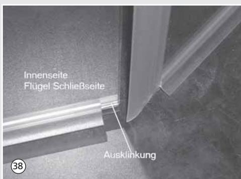
38. Bei Bedarf kann an der Wannendichtung vom gebogenen Flügel eine Ausklinkung für die Dichtlippe der Spaltdichtung vorgenommen werden. Spaltdichtung liegt dann dichter am Flügel Schließseite an.
