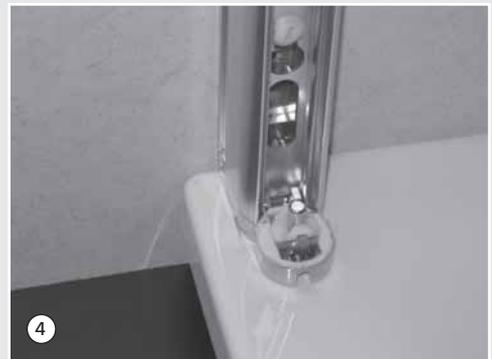
5. Gelenkeinheit nach oben ca. 10 mm aus dem Lot, nach außen, ausrichten. Dadurch stehen die Scheibenkanten bei geschlossener Tür lotrecht zueinander.
