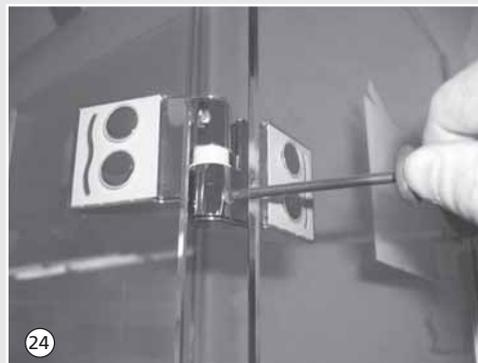
25. Beschlagabdeckungen montieren. Dabei Zuordnung Links „L“ und Rechts „R“ beachten. Vor Montage der Beschlagabdeckungen nochmals alle Befestigungsmuttern M8 mit einem Drehmoment von 12 Nm anziehen.
