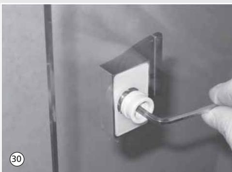
30. Erste Griffhälfte gemeinsam mit Griffunterlage mittels Senkschraube M6x20 und Befestigungshülse aus Kunststoff auf Scheibe fixieren.
