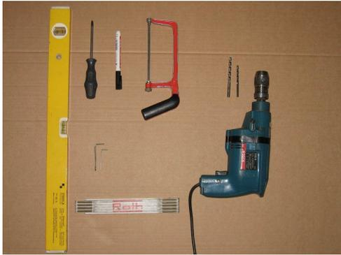
Schlagbohrmaschine mit Steinbohrer
