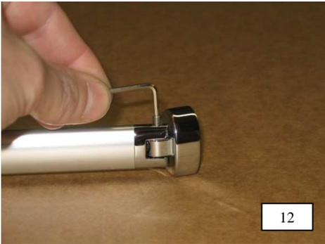
12. Gelenkkopf und -platte in umgekehrter Reihenfolge am gekürzten Halterohr montieren.
