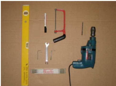
Schlagbohrmaschine mit Steinbohrer
