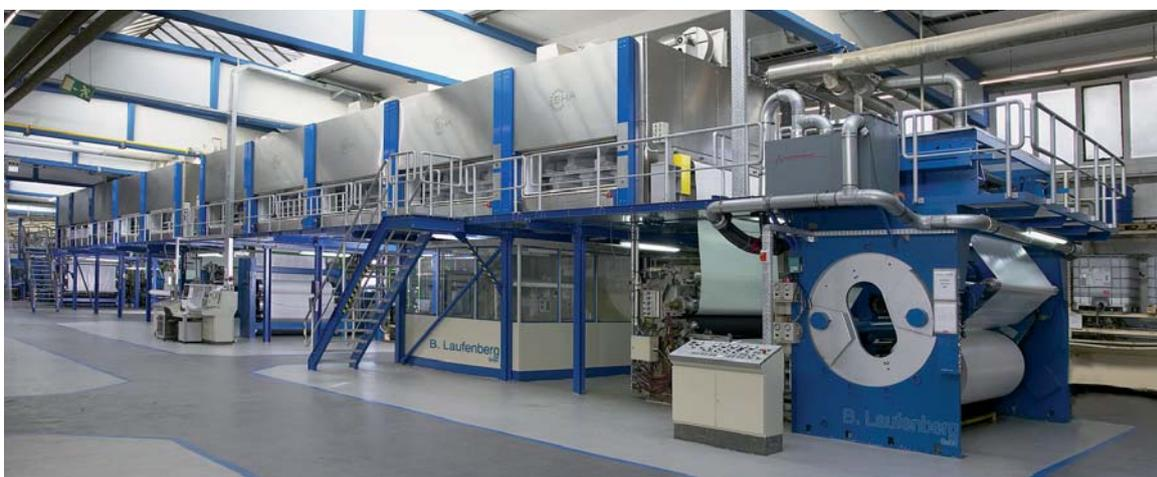
Schwebetrockner für Imprägnier- und Beschichtungsanlagen
