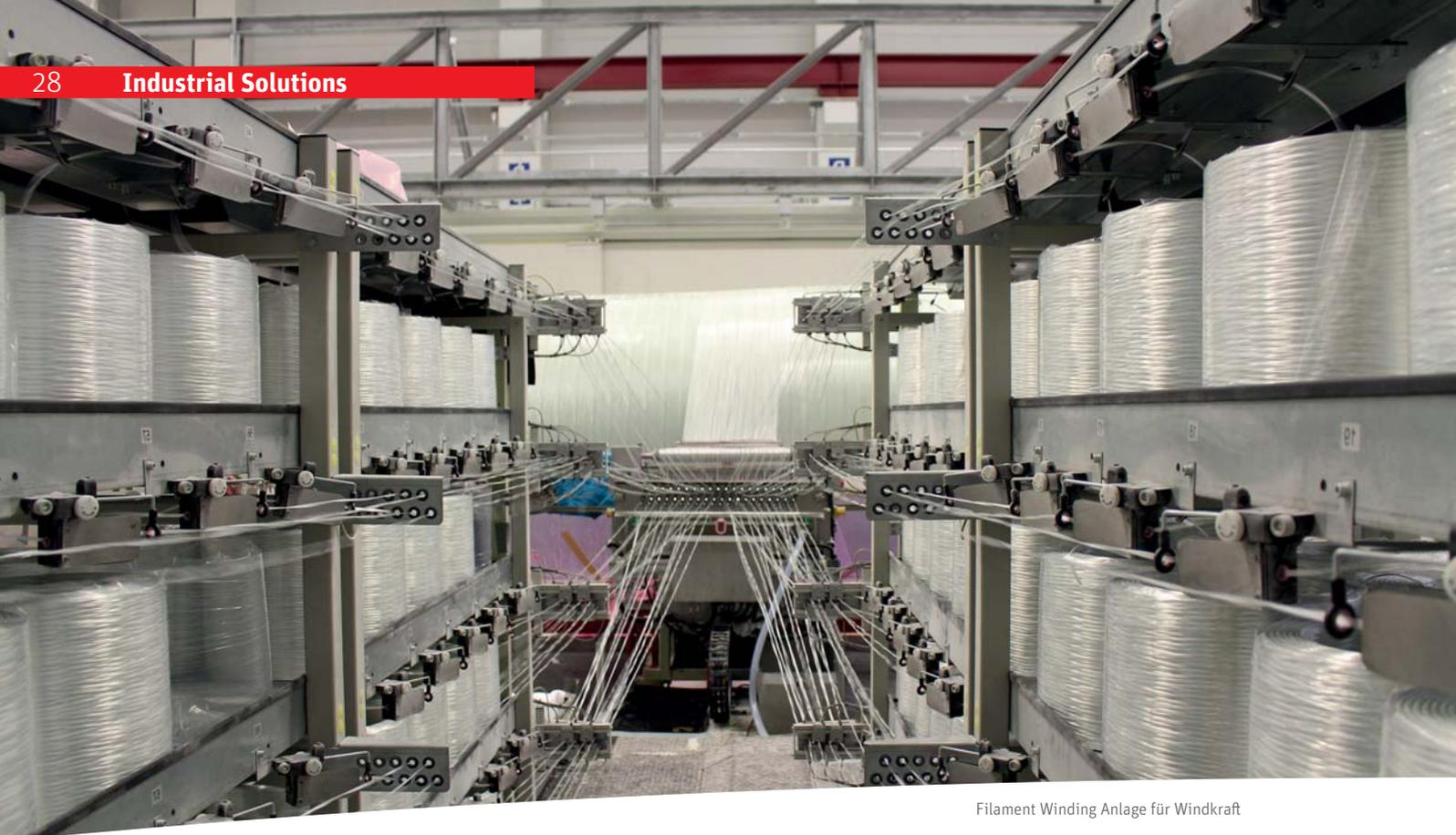
Filament Winding Anlage für Windkraft
